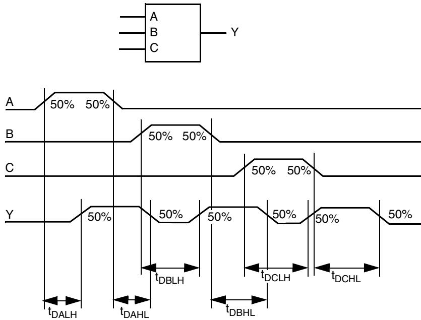
**Figure 20 • Module Delays**
